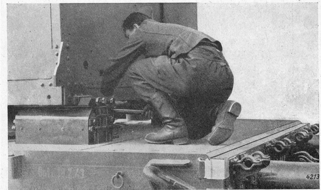
Bild 42. Bedienungshaus mittels der Spindelwinden (IV/5) anheben. Drehscheibe (IV/2) lösen und drehen, so daß sich die Schienen der Scheibe unter den Rollen am Bedienungshaus und die Bremsklötze an den Schienen auf der rechten Seite des Wagens IV befinden. Bedienungshaus senken, so daß es auf den Schienen der Drehscheibe steht. Bremsklötze ansetzen.
