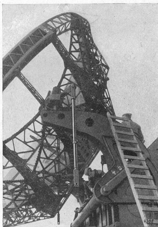
Bild 37 und 38. Spiegelzugstangen nun zuerst am Hebelarm des Spiegels und dann erst am Zahnradsektor der Kippachse befestigen. Dabei ist der Haltebolzen von innen nach außen einzuführen.
