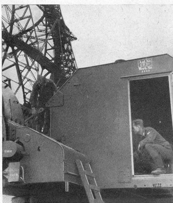
Bild 52. Befestigung der Zugstange am Bedienungshaus.
